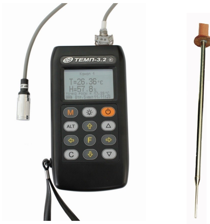
Рисунок 2- Общий вид прибора модификации «ТЕМП-3.21», «ТЕМП-3.22» с дополнительным датчиком температуры среды погружным ТЗ-С
