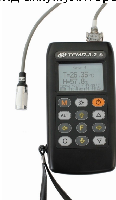
Рисунок 1- Общий вид прибора модификации «ТЕМП-3.20» с совмещенным датчиком температуры и влажности ДТГ
