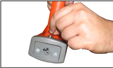
а) Выдвинуть фиксатор и освободить батарейный отсек
