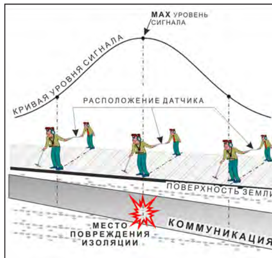
применение датчика-определителя дефектов коммуникации (ДОДК) методом max
