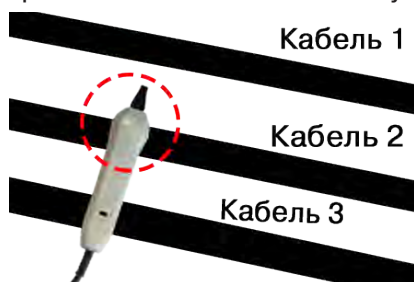
Выбор кабеля по максимальному сигналу
