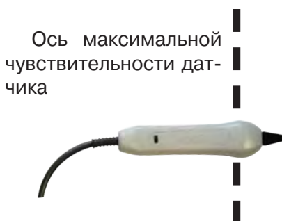
Выбор кабеля по максимальному сигналу
